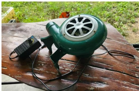
รูปภาพที่ 3.8 พัดลมเติมอากาศในเตาชนิดหอยโข่ง ขนาด 6 นิ้ว
