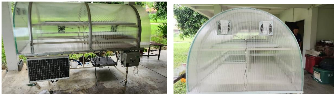
รูปภาพที่ 3.2 โรงอบตากพลังงานแสงอาทิตย์แบบพาโบล่า ชนิดเคลื่อนที่ ขนาด กว้าง 1.2 เมตร ยาว 2.0 เมตร สูง 1.6 เมตร
