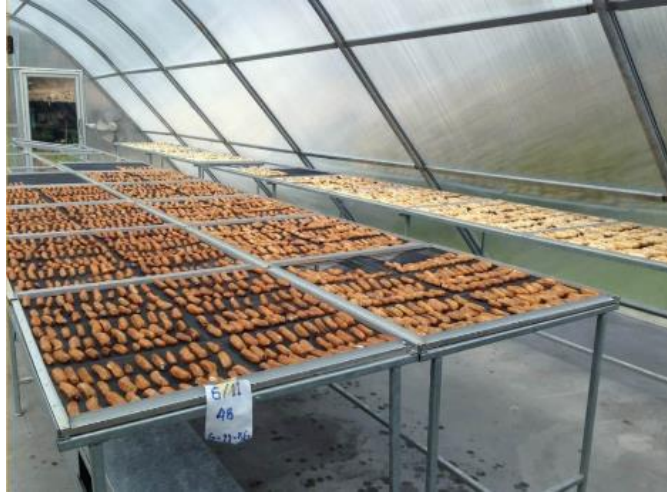
รูปภาพที่ 2.2 โดมอบแห้งที่ใช้พลังงานแสงอาทิตย์และมีพัดลมช่วยระบายอากาศ
