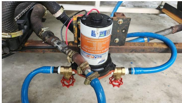
รูปภาพที่ 3.7 ปั้มน้ำขนาด 1/2 นิ้ว แรงดันไฟฟ้า 12 Volt สำหรับไหลเวียนน้ำในระบบ
