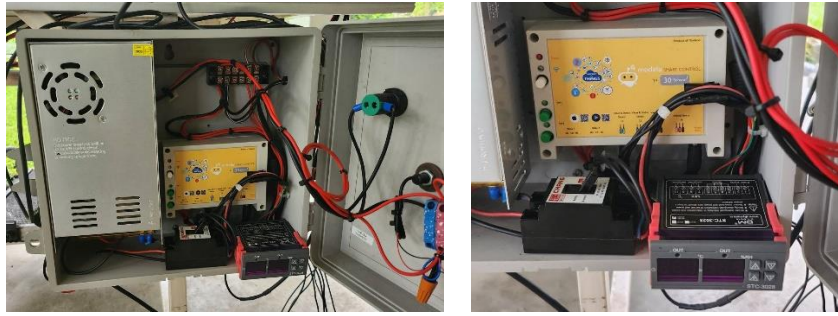
รูปภาพที่ 3.9 ชุดควบคุมอุณหภูมิและความชื้น
