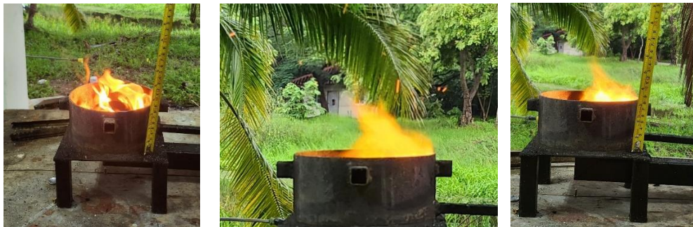
รูปภาพที่ 4.1 ลักษณะการจุดติดไฟอัตราจ่ายเชื้อเพลิง 0.25 ลิตรต่อชั่วโมง ระดับอากาศ 3 ระดับ
