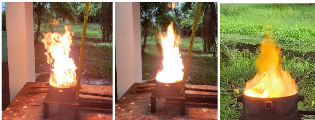
รูปภาพที่ 4.4 ลักษณะการจุดติดไฟอัตราจ่ายเชื้อเพลิง 1.00 ลิตรต่อชั่วโมง ปรับอากาศ 3 ระดับ
