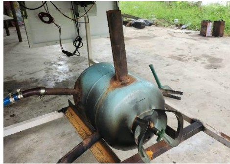
รูปภาพที่ 3.5 ดัดแปลงหม้อต้มจากถังน้ำยาแอร์เก่า
