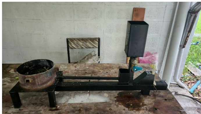
รูปภาพที่ 3.3 ชุดเตาเผาแบบใช้น้ำมันเก่าเป็นเชื้อเพลิง
