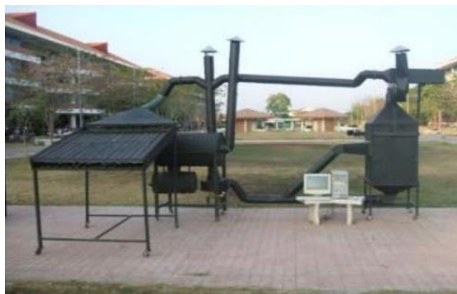
รูปภาพที่ 2.3 โดมอบแห้งที่ใช้พลังงานแสงอาทิตย์และพลังงานในรูปแบบอื่น
