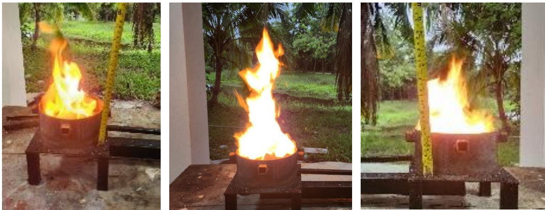
รูปภาพที่ 4.3 ลักษณะการจุดติดไฟอัตราจ่ายเชื้อเพลิง 0.75 ลิตรต่อชั่วโมง ปรับอากาศ 3 ระดับ
