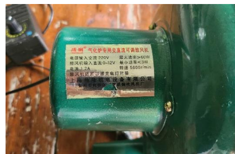
รูปภาพที่ 3.8 พัดลมเติมอากาศในเตาชนิดหอยโข่ง ขนาด 6 นิ้ว
