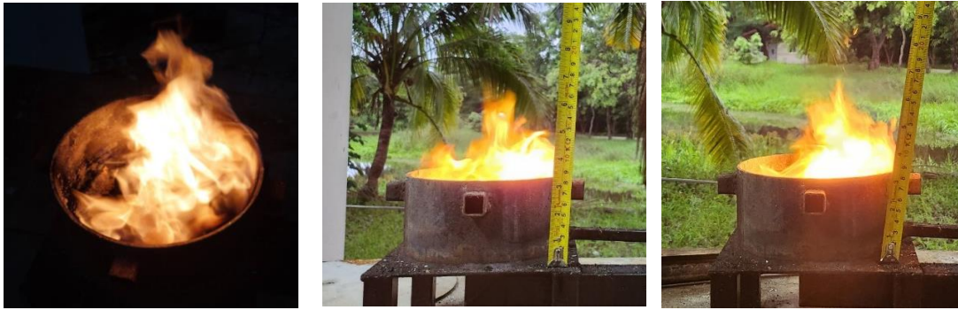
รูปภาพที่ 4.2 ลักษณะการจุดติดไฟอัตราจ่ายเชื้อเพลิง 0.50 ลิตรต่อชั่วโมง ปรับอากาศ 3 ระดับ
